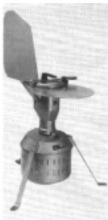
Fig. 5. Burkard Seven Day Volumetric Spore-Trap®. Basado en el mismo principio del colector de Hirst, pero que permite un muestreo ininterrumpido de 7 días.
